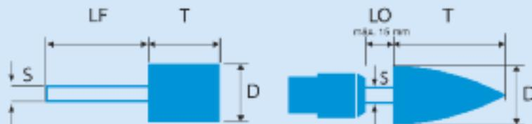
**ATENCIÓN:** Se pueden fabricar a pedido especial con vástago de 3 y 6 mm. Las boquillas para  $\varnothing$  3,2 mm (1/8") y 6,4 mm (1/4") no ajustan  $\varnothing$  3 y 6 mm respectivamente.
