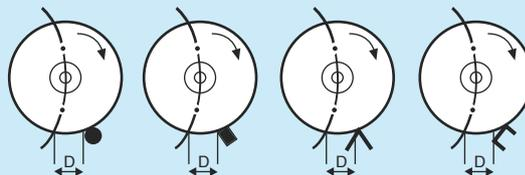
Al cortar perfiles, es conveniente que haya una distancia (D) entre la pieza a cortar y el radio de desplazamiento del cabezal de la máquina. Es decir, se debe desplazar la pieza a cortar respecto del radio de desplazamiento del cabezal de la máquina. Ver ejemplos de la posición y de la distancia (D) a la que deberían fijarse algunos perfiles.
